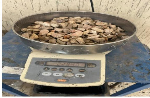
شكل 7 : وزن كمية الركام الخشن باستخدام الميزان الحساس
