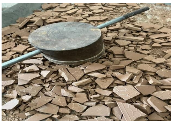
شكل 3 : يوضح تجهيز وطحن بقايا مخلفات السيراميك
