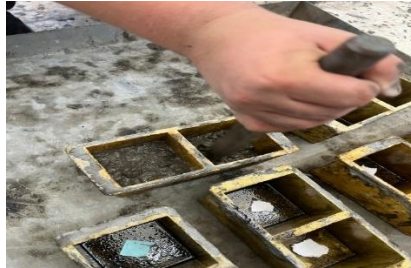
شكل 9 : تجهيز العينات الخرسانية وصبها في قوالب
