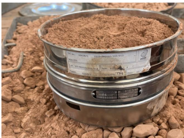
شكل 5 : نخل عينة بودرة السيراميك على المنخل رقم 200
