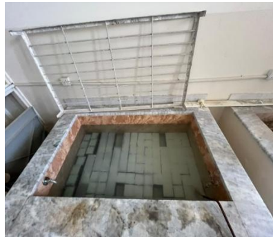
شكل 12 : غمر العينات في أحواض المعالجة المائية لمدة 28 يوم
