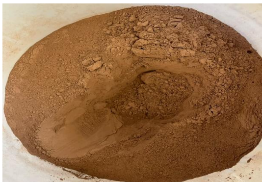
شكل 6 : عينة بودرة مخلفات السيراميك بعد النخل على المنخل 200
