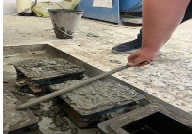
شكل 10 : تسوية السطح النهائي للعينات
