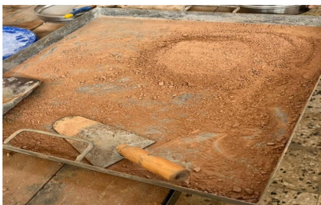
شكل 4 : يوضح نتيجة طحن مخلفات السيراميك قبل عملية نخلها على المنخل رقم 200
